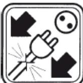
Avant chaque utilisation, contrôlez la machine, le cordon et la fiche. N'utilisez pas l'appareil s'il est endommagé et demandez l'intervention d'un technicien spécialisé. N'ouvrez jamais l'appareil.
