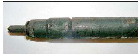
Este injetor foi alojado corretamente; o alojamento e as anilhas de cobre impediram que ocorresse o fenómeno de vazamento.
