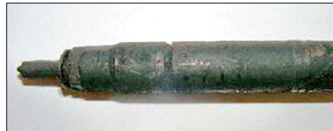
Este inyector se ha alojado correctamente; el alojamiento y las arandelas de cobre han impedido que se produzca el fenómeno del trefilado.
