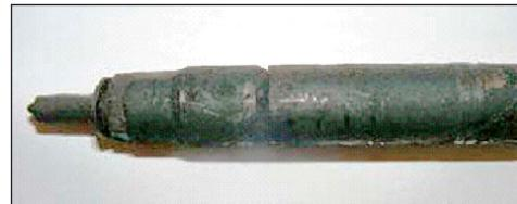
Questo iniettore è stato alloggiato correttamente; la sede e le rondelle di rame hanno impedito il verificarsi del fenomeno di trafilamento.
